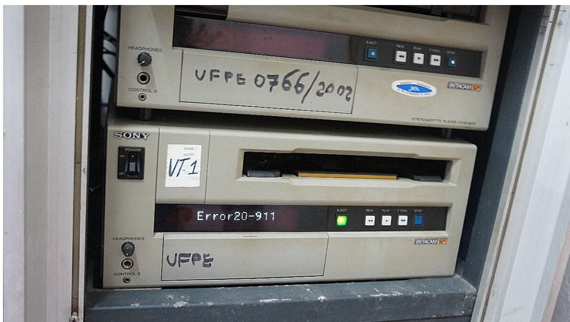
Figura 3 - A fita não solta, o carro da fita fica na posição para baixo. Foto: Charles Douglas Martins
